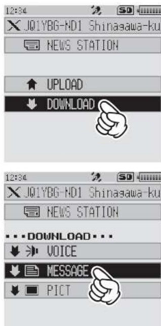
Rys.3.22. Wybór kierunku transmisji wiadomości i ich rodzaju. W tym przykładzie – wiadomości tekstowej
