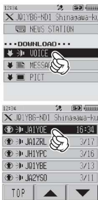
Rys. 3.27. Odsłuch wiadomości głosowych z wybranej kategorii wiadomości z węzła lokalnego lub odległego
