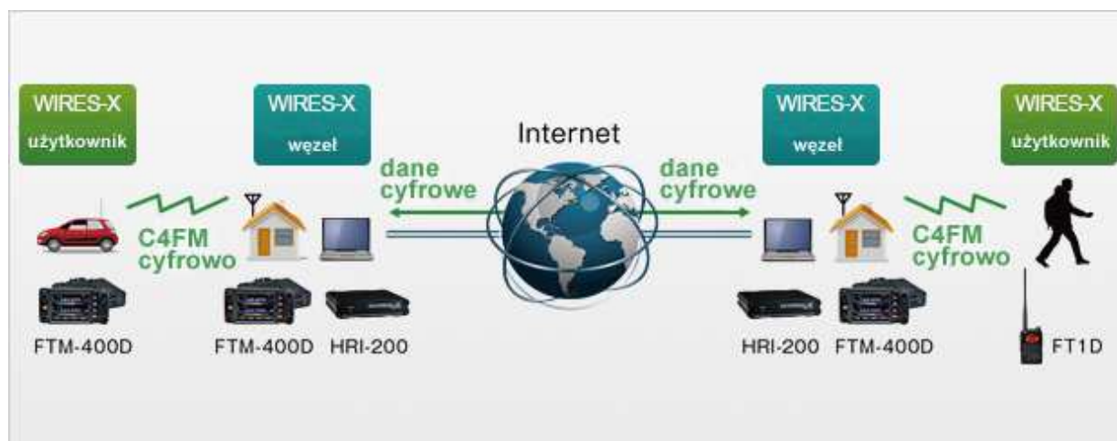
Rys. 3.1. Połączenia przemienników przez WIRES-X
