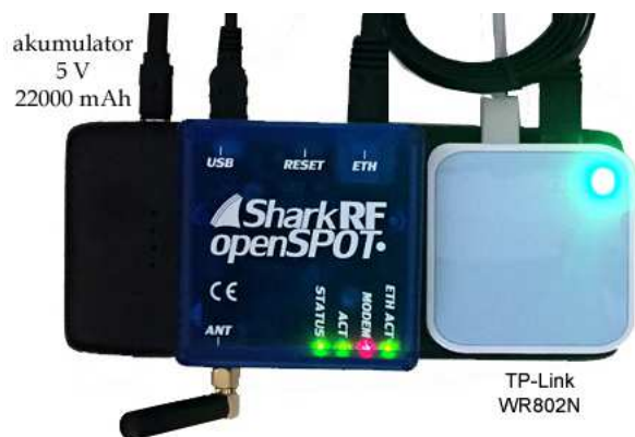
Fot. 2.15. Podręczny mikroprzełicznik dla cyfrowego głosu z zasilaniem akumulatorowym i przemiennikiem WiFi zapewniającym połączenie ethernetowe
