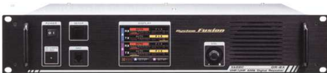
Fot. 2.20. Przeмиennik DR-2X. Do pracy w sieci YAESU konieczny jest dodatkowy moduł LAN-01A. Moc wyjściowa jest przełączana między 50 W, 20 W i 10 W. Przeмиennik jest wyposażony w funkcję automatycznego przełączania na awaryjne zasilanie z akumulatora
