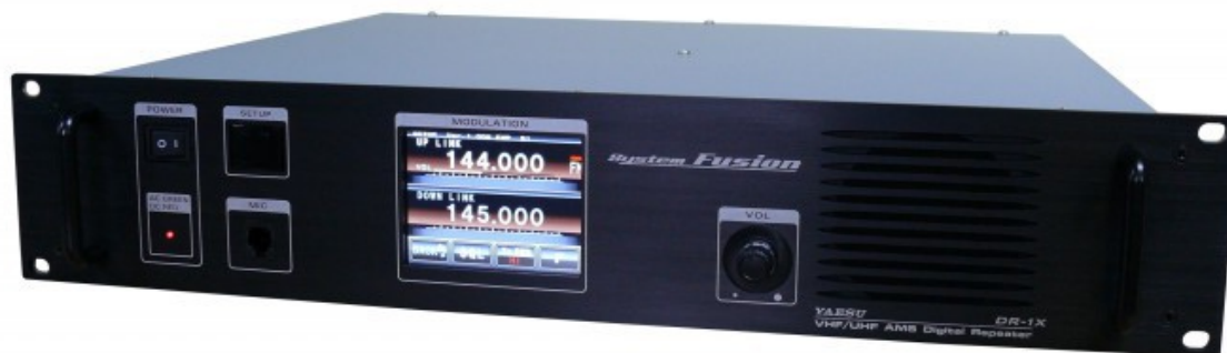
Fot. 2.18. Przeziennik DR-1XE zawiera wewnątrz dwie radiostacje FTM-400DE
